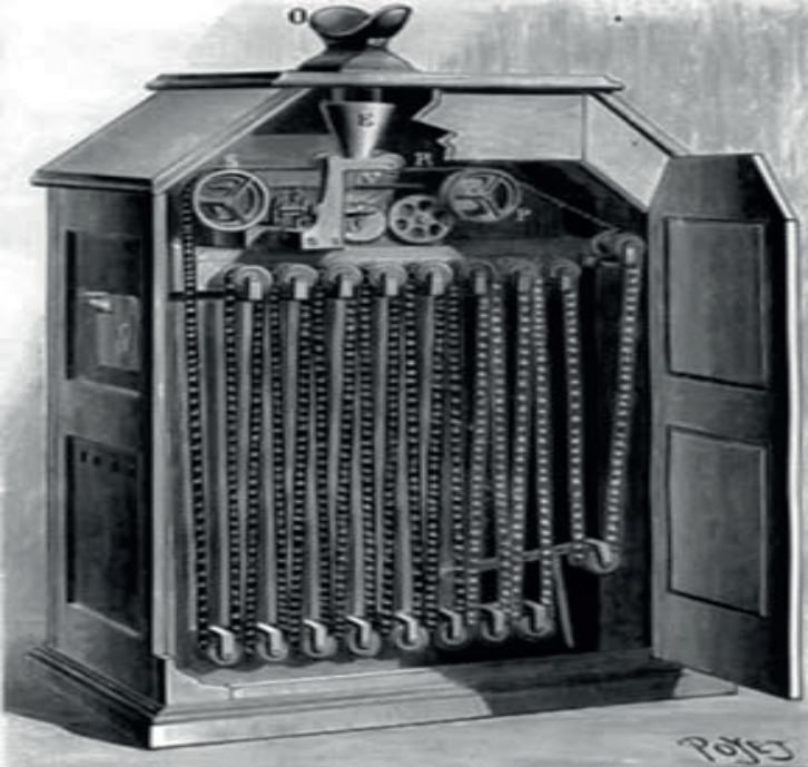
Edison'un kinetoskop'u (Küçükcan ve d., 2013:19).
